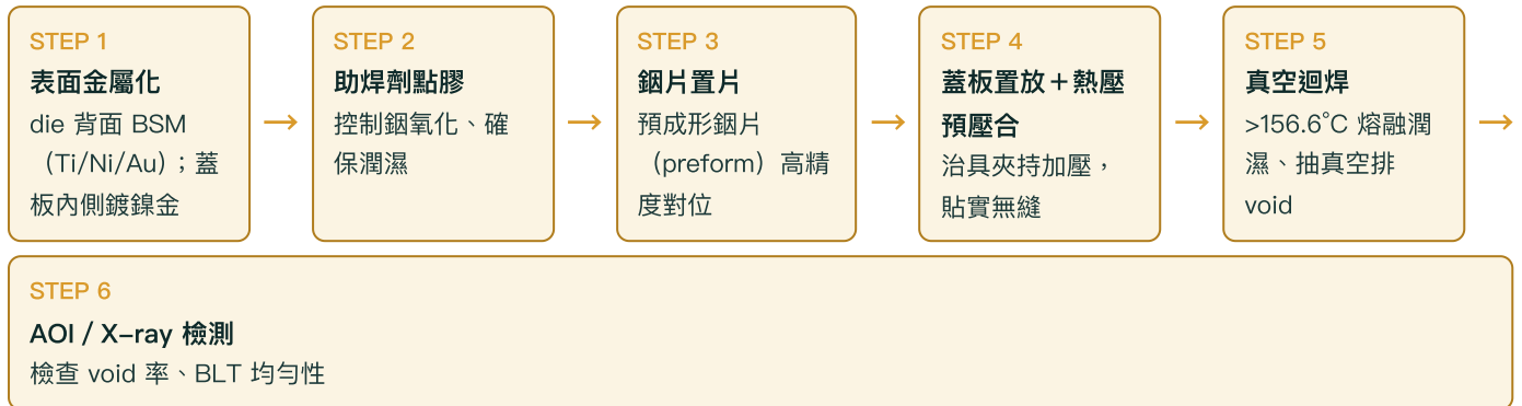
圖 7 | 鋼片 sTIM 焊接路線完整製程流程（自繪，依 Indium Corporation 官網製程說明與設備商公開資訊整理）。純壓合路線則跳過 STEP 1 / 2 / 5，以鎖固機構的持續壓力取代冶金接合。
