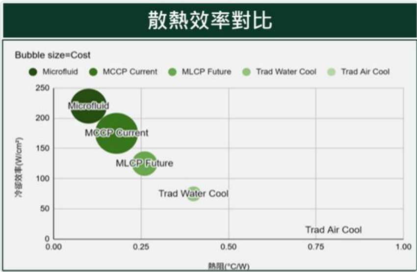
圖 13 | 五種方案的效率—熱阻定位（泡泡大小=成本）。X 軸熱阻 (°C/W)、Y 軸冷卻效率 (W/cm²)：Microfluid（晶片內微流道）效率最高、熱阻最低但成本最高；MCCP 是現在量產可行的甜蜜點；MLCP / 傳統水冷 / 氣冷依序退後。來源：內部散熱產業簡報（2026-06-30）。
