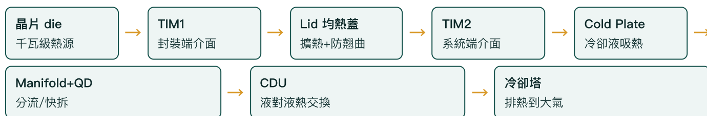
圖 4 | 熱路徑全鏈（自繪）。封裝內每層介面吃掉的溫差稱為「熱阻預算」；功耗越高，每層介面能容忍的熱阻越小，材料與製程就被迫升級。
