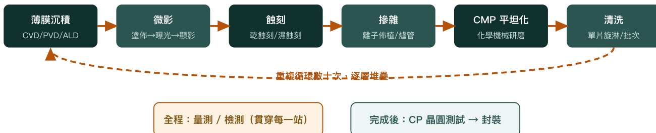
圖 4 | 八大製程步驟的循環關係。量測檢測不是一個「站」，而是貫穿所有站之間的品質關卡。自繪整理。
