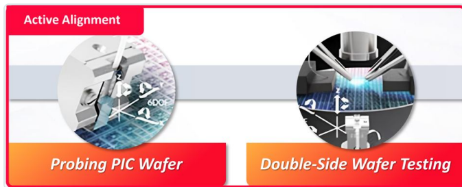
圖 16：主動對位的兩個場景。左為「探測光子晶圓」（探針對光子晶圓針測，標示六自由度對位軸）；右為「雙面晶圓測試」（上方電性探針、下方光路）。分別對應上表的第一段與第二段插入測試。來源：穎威 CPO 論壇簡報，2026-05-14（本研究資料庫既有素材）。
