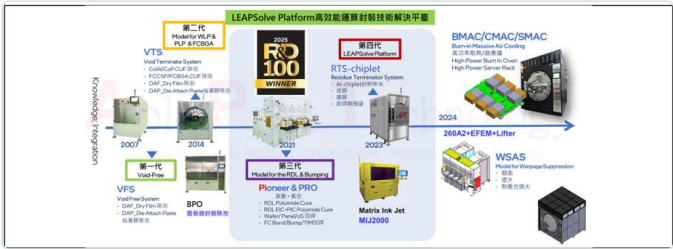
圖 8 | 印能 LEAPSolve 平台演進 (戰場一代表)。從 VFS/VTS 除泡（第一、二代）→ Pioneer&PRO (RDL/Bumping 高壓真空固化，第三代) → RTS-chiplet 殘留物去除（第四代），右側 WSAS 即翹曲抑制系統（翹曲/退火/熱壓合退火）。產品線沿著「molding / 固化段」的翹曲物理逐代加碼。來源：玉山投顧，2026-07-06。
