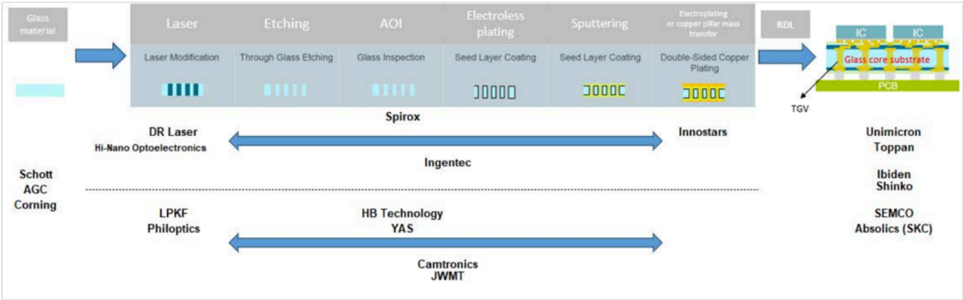
圖 3-3 | 玻璃芯基板製程流程與供應商對應。雷射成孔（Laser Modification）→ 蝕刻（Through Glass Etching）→ AOI 檢測（Glass Inspection）→ 化學鍍種子層（Electroless / Seed Layer Coating）→ 濺鍍（Sputtering）→ 雙面電鍍銅（Electroplating）→ RDL；玻璃材料端為 Schott / AGC / Corning，成孔設備端見 DR Laser、Hi-Nano Optoelectronics、LPKF、Philoptics 等，後段基板廠含 Unimicron（欣興）、Ibiden、Shinko、SEMCO、Absolics（SKC）。
