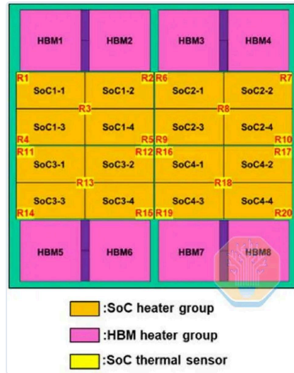
圖 3-1a | 台積電 CoWoS-R 測試載具平面圖：4 顆 SoC（各含 4 組加熱器群）+ 8 顆 HBM 加熱器群，R1-R20 為熱感測器位置——SoC 加熱區約覆蓋中介層一半面積。來源：TSMC, ECTC 2026 (SemiAnalysis 轉載)
