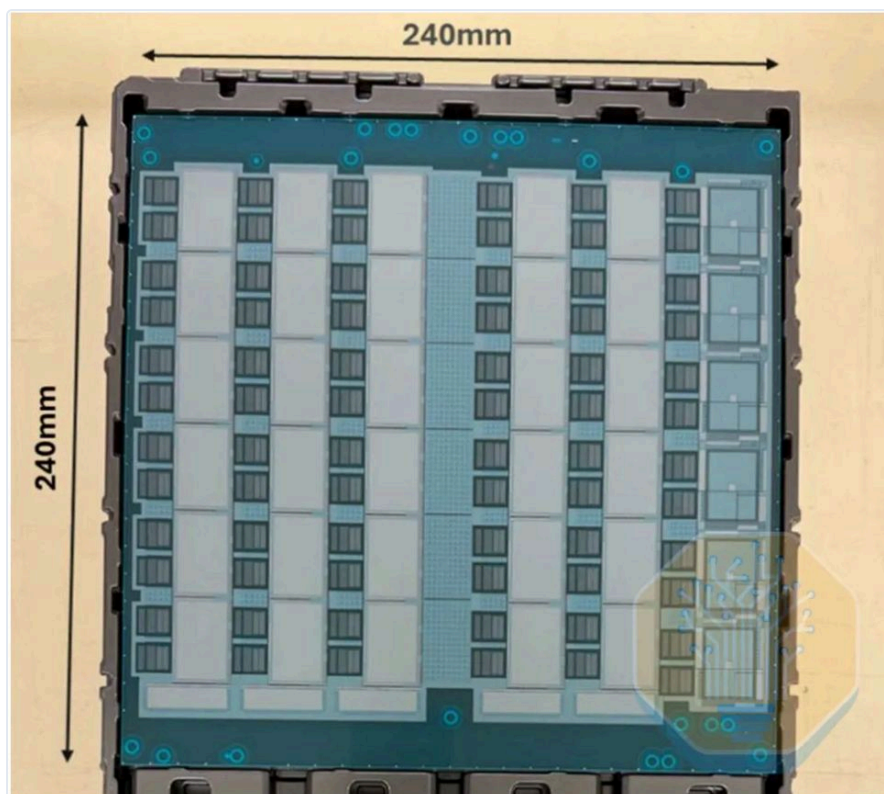
圖 1-7 | Intel 240mm×240mm quarter-panel EMIB-T 測試載具實照（約 67 reticles），格狀晶粒陣列。SemiAnalysis 現場觀察樣品翹曲嚴重。來源：Intel, ECTC 2026（SemiAnalysis 轉載）
