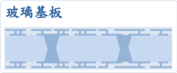
圖 4 玻璃芯基板截面示意：中央玻璃片內的沙漏狀通孔即 TGV（雙面蝕刻使孔呈中間細、兩端寬的腰鼓/沙漏形），孔內鍍銅垂直導通，玻璃上下再做 RDL 銅線層。來源：福邦投顧《2026 台灣半導體特化與耗材展望》2026-03。
