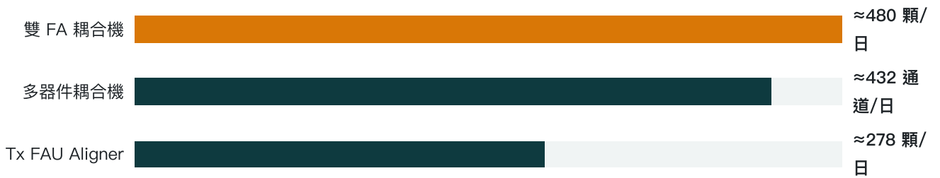
圖 7：依官網週期時間換算之單機理論日產出（24 小時連續運轉、不計換料與停機）。雙 FA 耦合機以 180 秒/顆計、多器件以 200 秒/通道計、Tx Aligner 以 310 秒/顆計。實際稼動須再打折。
