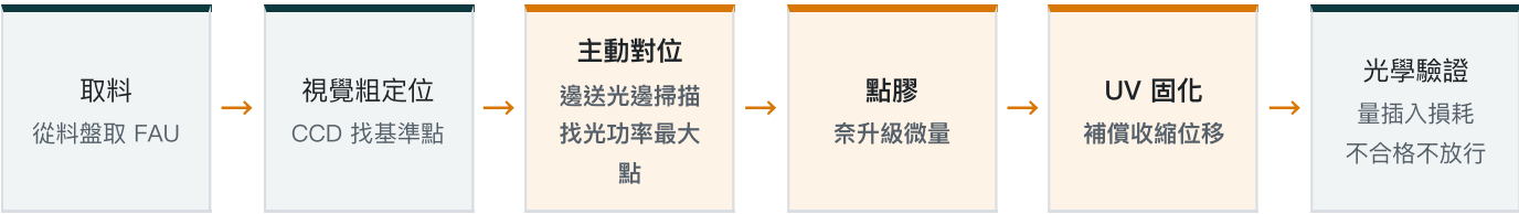
圖 1：耦光機的單顆作業流程。琥珀色為決定良率的三個關鍵動作。資料來源：本報告依三家公司官網製程說明整理繪製。
