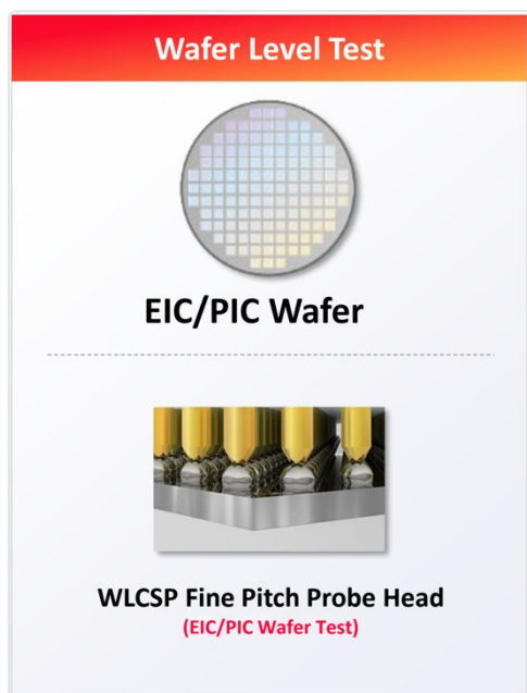
圖 1 | 晶圓級測試。 上為 EIC / PIC 晶圓，下為 WLCSP 細間距探針頭（Fine Pitch Probe Head）——照片可見成排彈簧探針壓在焊球陣列上。此階段在切割前完成，是把不良品攔在最便宜位置的關鍵。來源：穎崙科技 CPO 論壇簡報，2026-05-14
