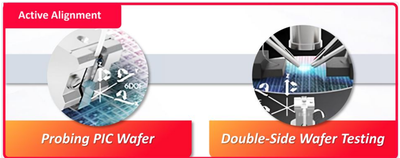
圖 6 | 主動對位的兩個實際場景。左「Probing PIC Wafer」——探針對 PIC 晶圓針測，圖上疊有標示 6DOF（六自由度）的座標軸；右「Double-Side Wafer Testing」——雙面晶圓測試，可見上方電性探針落下、下方光路發出藍光。兩者分別對應 Insertion 1 與 Insertion 2。 來源：穎威科技 CPO 論壇簡報，2026-05-14
