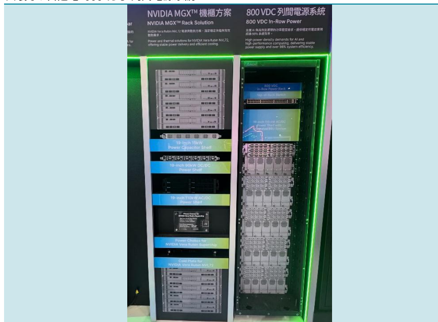
圖表 5：台達電 800 VDC 列間電源系統
