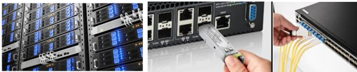
圖 1：光收發模組為交換機與光纖之間橋樑，以插拔方式與交換機連接
