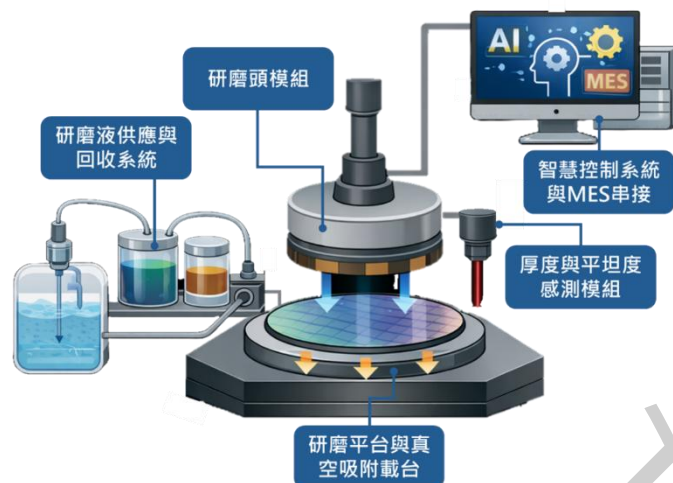
圖 15、研磨設備關鍵模組結構示意圖
